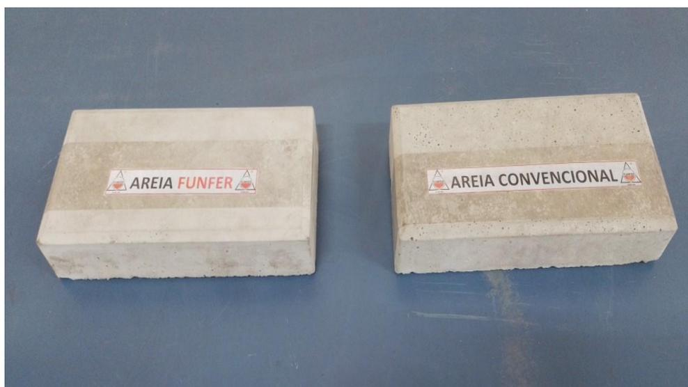
Figura 5: Bloquetes produzidos com areia de fundição (à esquerda) e com areia convencional (à direita)
